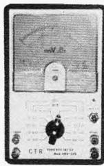
**CTR-Millivolt-Röhrenvoltmeter HRV 260**
