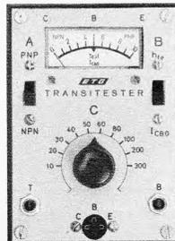
Universal-Transistor- und Diodentestgerät für NF, RF, FS-Service sowie Industrie-Elektronik.
