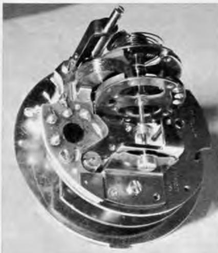
Bild 11. Ausführungsform einer Uhr, in der die integrierte Schaltung TAA 780 eingesetzt ist
