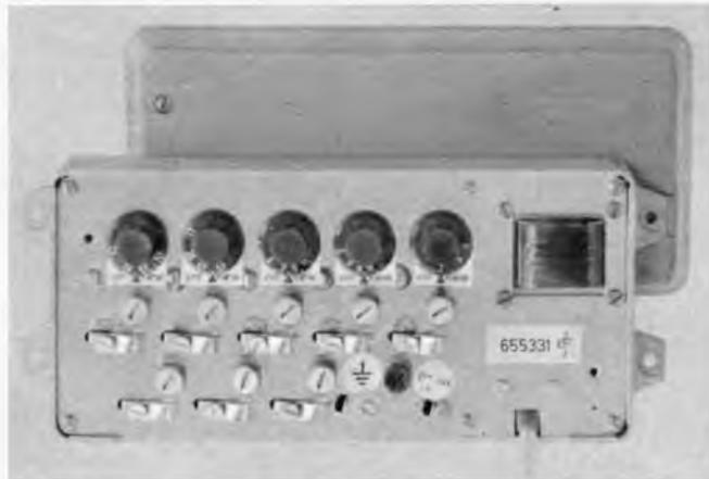
Bild 2. Ansicht eines Kombinationsverstärkers der Typenreihe 600 000 mit eingebautem Netzteil
