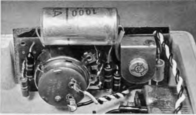
Bild 5. Ansicht des fertigen Taktgebers, eingebaut in einen Dia-Projektor Liesegang J 24 Halbautomat
