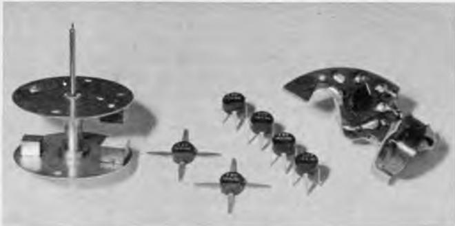
Links: Bild 9. Die beiden Ausführungsformen der integrierten Schaltung TAA 780 im Größenvergleich
