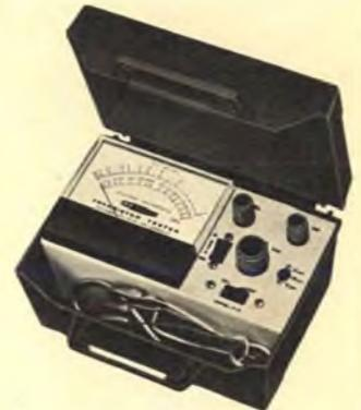
Ermöglicht Verstärkungsmessungen von 2...100 und von 20...1000  $\beta$  an ein- und ausgebauten Transistoren, ferner Kollektor-Reststrommessungen bei offener Basis und offenem Emitter bis 5000  $\mu$ A sowie Elektrodenschlußprüfungen an allen herkömmlichen Halbleitern • Prüft Dioden in Sperr- und Durchlaßrichtung bis 5000  $\mu$ A • Bestimmt die Polarität unbekannter Transistoren (pnp und npn) und hilft bei der Zusammenstellung geeigneter Transistorpaare für Komplementärschaltungen
