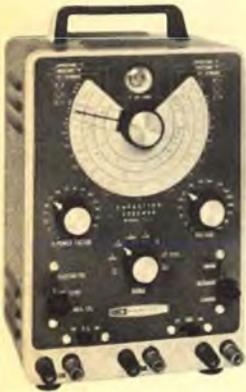
Zur Prüfung und Wertbestimmung von Kondensatoren zwischen 10 pF und 1000  $\mu$ F, Widerständen zwischen 5  $\Omega$  und 50 M $\Omega$ , desgleichen für L-Messungen mit externem Vergleichsnormale • Impedanzverhältnis bei Verwendung externer Vergleichswiderstände und Kondensatoren jeweils 25:1 • Isolationsprüfung von Kondensatoren mit Prüfspannungen von 3 V bis 600 V in 16 Stufen möglich
