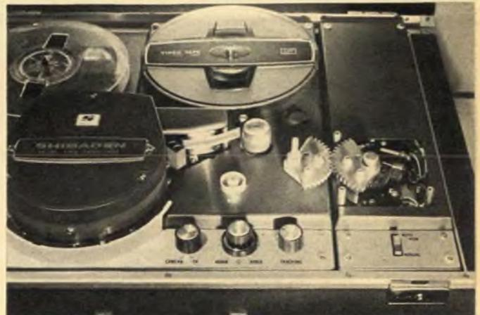
Bild 3. Rechts die angebaute Umschaltvorrichtung für den automatischen Bandrücklauf
