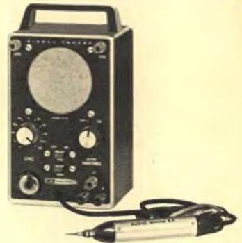
Auf HF und NF umschaltbare Tastspitze • Eingangsempfindlichkeit bei NF ca. 2 mV, bei HF ca. 5 mV • Optische Anzeige durch magisches Auge, akustische Anzeige durch eingebauten Kontrolllautsprecher • Frequenzbereich 50...8000 Hz • Eingebaute „Krachprüfschaltung“ zum schnellen Einkreisen von Aussetzfehlern und kalten Lötstellen • Unser IT-12 E ist auch als Kontrolllautsprecher mit oder ohne Ausgangsübertrager zur Instandsetzung von Phonogeräten verwendbar
