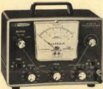
Liefert rein sinusförmige Tonfrequenzspannungen zwischen 1 Hz und 100 kHz in 8 Bereichen zwischen 3 mVeff und 15 Veff ● Dekadische Frequenzeinstellung durch zwei Drehschalter und Feineinstellung ● Genauigkeit  $\pm 5$  % ● Klirrfaktor unter 0,1 % ● Zuschaltbarer 600- $\Omega$ -Abschlußwiderstand ● Einbau-Drehspulinstrument zur Kontrolle der Ausgangsspannung mit zusätzlicher dB-Skalenteilung von -65...+22 dB
