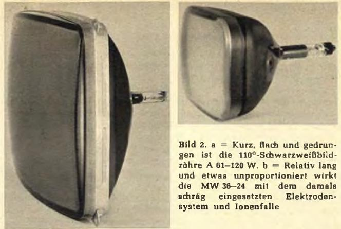
Bild 2. a = Kurz, flach und gedrun- gen ist die 110°-Schwarzweißbild- röhre A 61-120 W. b = Relativ lang und etwas unproportioniert wirkt die MW 36-24 mit dem damals schräg eingesetzten Elektroden- system und Ionenfalle
