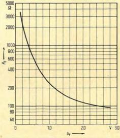
Bild 26. Durchlaß- oder Flußwiderstand  $R_{\rm F}$  einer Germaniumdiode AA 119 in Abhängigkeit von der in Flußrichtung anliegenden Spannung  $U_{\rm F}$
