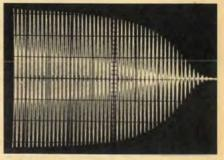
Bild 8. Oszillogramme des abklingenden, amplitudenmodulierten Tonsignals am Lautsprecher bei extrem langsamer Zeitablenkung. Zeitablenkung: 50 s/Teil. Vertikalsblenkung: 3 V/Teil
