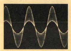
Bild 4. Oszillogramm des amplitudenmodulierten Tonsignels am Lauteprecher, über eine Modulationsperiode gespeichert. Zeitablenkung: 5 ms/ Teil. Vertikalablenkung: 3 V/Teil. Frequenz: 30 Hz
