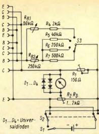
Bild 3. Schaltung des β-Meßgerätes mit Meßbrücke
