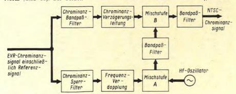
Bild 11. Umsetzung des EVR-Signals in die NTSC- bzw. Pal-Norm
