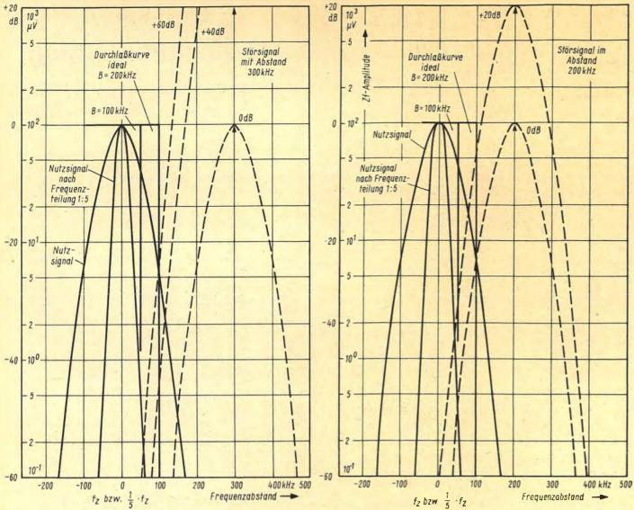
Bild 9. Umhüllende der Seitenbandspektren von Nutz- und Störsignal bei 300 kHz Kanalabetand und 100 % Modulation
