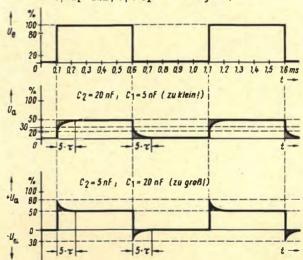
Bild 5.7. Frequenzkompensierter Spannungsteiler, Übertragung einer Rechteckimpulsfolge bei Fehlabgleich
