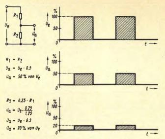
Bild 5.5. Galvanische Kopplung eines Rechteckpulses über zwei verschiedene Spannungsteiler
