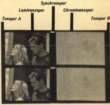
Bild 1. Aufbau einer Schwarzweiß-EVR-Kopie (links) und einer Farbkopie, Bei der Farbkopie ist die zweite Luminanzspur durch das codierte Farbsignal ersetzt
