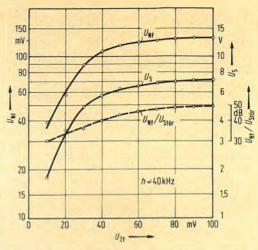
Bild 27. Zur Arbeitsweise des Ratiodetektors.  $U_{\mathrm{Nf}}=\mathrm{Tonfrequenzspannung},\ U_{\mathrm{S}}=\mathrm{Summenspannung}$  und gestrichelt die Störunterdrückung in dB, sämtlich in Abhängigkeit von der Zf-Eingangsspannung
