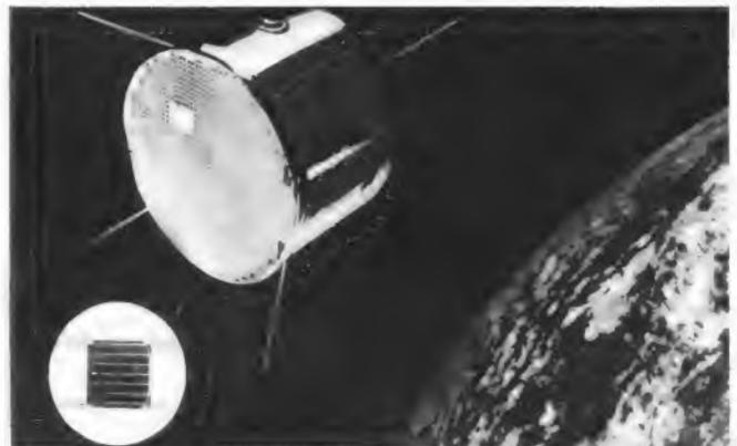
Links: Solarzelle mit beschichtetem Deckglas und Aluminiumverbindungsdrähten. Die leitende Schicht ist mit dem Auge kaum wahrnehmbar. Mitte: Der Aeros-Satellit, für den die Schichten projektiert waren. (Fotomontage: Dornier System GmbH und Philips)
