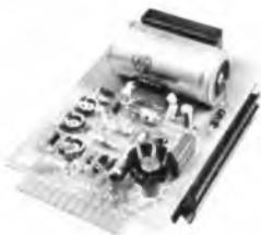
Ausgangsspannung: 0–24 V. Ausgangsstrom: 1 A. Einstellbare Strombegrenzung: 100 mA–1 A. Brumm: etwa 1 mV. Stat. Innenw.: 0,2  $\Omega$ . Dyn. Innenw.: 0,5  $\Omega$ . Erforderliche Trafospaltung: 27 bis 31 V $\sim$ /1,5 A. Maße: 75 x 120 x 70 mm.
