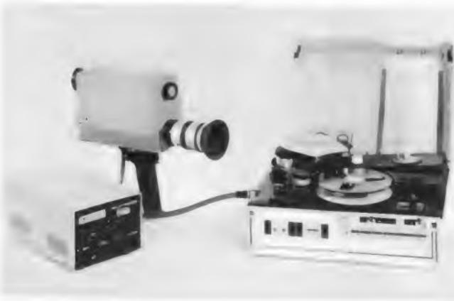
Tragbare Fernseh-aufzeichnungsanlage von Nivico mit  $\frac{1}{2}$ -Zoll-Band. Die Kamera enthält neben dem Mikrofon oberhalb des Objektivs einen elektronischen Sucher, der zugleich als Monitor benutzt werden kann. Links im Bild das Netz- und Batterieladegerät
