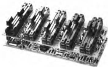
Eingang: 200 mV/50 k $\Omega$ . 5 Klangsteiler in Flachbahnreglerausführung, kontin. einstellbar. Toleranz:  $\pm$  3 dB. Ausgangs-Impedanz: etwa 10 k $\Omega$ . Verstärkung: 0 dB. Stromversorgung: 24–30 V/etwa 20 mA; mono. Maße: 180 x 85 mm.
