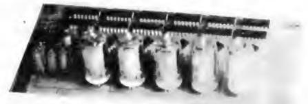
**Digitales Frequenz-Meßgerät**. 182 x 92 mm, bis 20 MHz, 5 Dekaden, 17 ICs (Siemens, Texas Instruments). Komplett mit Printplatte 182 x 92 mm, 5 Nixiröhren (ZM 1000) oder 5 Nixiröhren ZM 1000 R (Rotüberzug).
