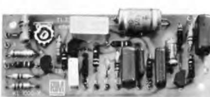
Empfindlichkeit: 100 mV f. ca. 1,4-V-Ausgang. Eingangsimpedanz: ca. 100 kΩ. Ausgangsimpedanz: ca. 10 kΩ. Höhen- und Tiefenregler: je ± 15 dB. Stromversorgung: 18 bis 32 V/10 mA. Maße: 100 x 40 x 20 mm.
