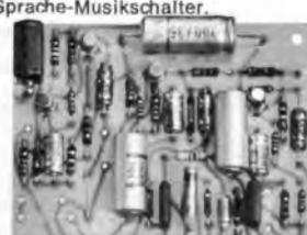
Eingangsspannung m. Balanceregler: ca. 200 mV. Eingangswiderstand: > 1 MΩ. Ausgangsspannung mit Balanceregler: ca. 3 V. Stromversorg.: 24–30 V/13 mA b. 17 V. Maße: 90 x 70 x 25 mm.
