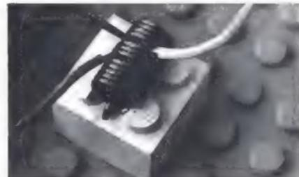
Bild 2. Einklemmen eines Schaltdrahtes mit einer Reißnadel (links)
