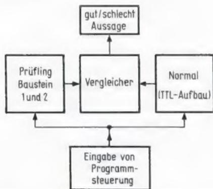
Bild 8. Blockschaltbild der Hardware-Testers für Scheiben- und Bausteinprüfung
