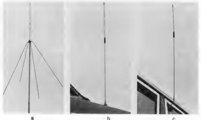
▲ Bild 4. Antennen für das 27-MHz-Band, a = Stata 27 GA, b = Moba 3700/1, c = Moba 116 K (Hirschmann)
