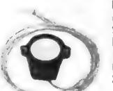
**Übertemperatur-Wächter.** Selbstschaltender Kontakt mit 2,5 A bei 24 V. Schaltet bei Erreichen von +100 °C ab und bei Abkühlung auf +40 °C wieder ein. Befestigung auf Kühlkörper oder dgl. möglich. Lange Anschlußdrähte. 30 x 35 x 10 mm ..... DM 2.50
