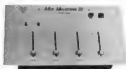
**Stereo-Mischpult Mixmaster IV. Professionelles Stereo-Mischpult** mit 5 Eingängen, Mikrofoneingang getrennt. Höhen und Tiefen regelbar. Bestückt mit 8 Operationsverstärkern (168 Si-Transistoren), 2 Gleichrichterdiode. Stromversorgung 220 V. Maße 280 x 160 x 70 mm hoch. 4 GummifüÙe, 6 Normbuchsen Stereo, Frontplatte Alu eloxiert, 340 x 180 mm. Herausgeführtes Netzkabel mit Stecker, Netzkontrolllampe.
