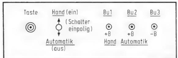
Bild 2. Anordnung und Beschriftung der Taste T, des Schalters S und der Ladebuchsen
