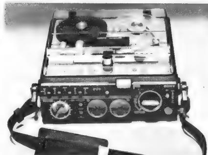
Bild 12. Transportables Studio-Tonbandgerät TC 510-2 (Sony)
