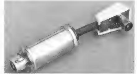
Bild 3. Steckbarer Hochpaß mit 40 MHz Grenzfrequenz von Blaupunkt
