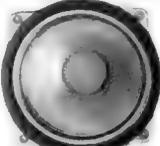
**Tiefenlautsprecher TL 200** für geschlossene Boxen. Deutsches Markenfabrikat. Belastbarkeit 40/60 W, Impedanz 4 Ω, Frequenz 20..6000 Hz, Eigenresonanz 30 Hz, Empfindlichkeit auf DIN-Schallwand gemessen, 90 dB. Ø 204, Einbautiefe 85 mm.
