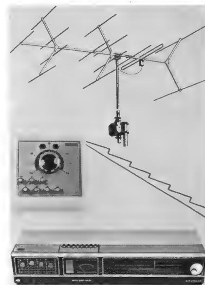
Bild 8. Rotorsteuerung durch die Stationstasten des Rundfunkempfängers. Oben UKW-Weitempfangsantenne US 14 V von Stolle
