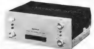
**Stereo 80, Hi-Fi-Endstufe** mit 2x 50 W Sinus an 8 Ω, Klirrfaktor unter 0,5 % bei Vollaussteuerung. Leistungsbandbreite 8 Hz bis 50 kHz bei Ausgangsspannung von 1,3 V bringt der Endstufe eine Leistung von 2x 40 W Sinus. Bestückung: 12 Transistoren, 10 Dioden.
