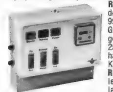
**RBZ-SW-PD:** mit Betriebsstundenzähler, max. Kapazität 9999,9 Stunden, 4 Anzeigelampen, rot und gelb abgedeckt, 3 Schiebeshalter 3 A/250 V~, 4 Schraubicherungshalter mit Feinsicherungen 5x 20, Klemmleiste 18polig **DM 34.50**
