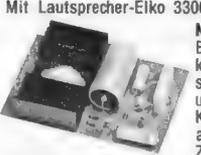
**Netzteil stabilisiert NST-50.** Für 2 Endstufen 50 W sowie Vorverstärker und Klangregelteil. Ausgangsspannungen +60 V für Endstufen und +20 V für Vorverstärker und Klangregelteil. Bestückt m. 2 N 3055 auf Kühlkörper, BC 140/10, BC 107, ZD 56, ZF 20, gedr. Plat. 150 mm.
