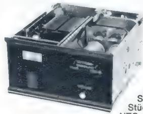
**Hi-Fi-Verstärker-Einschub 120 W Sinus** (1 Kanal) Besonders geeignet für Großraumbeschallung und Diskotheken. Dauerbelastbarkeit 120 W Sinus, mit Kurzschluß- und Übertemperatur-Sicherung, Epoxyd-Druckplatte (100 x 135 mm) mit Service-Druck im Europa-Steckkartonformat, 13 original Siemens-Transistoren, davon 4 Stück 2 N 4347, 6 Si-Dioden, Elkos, NTC, Zenerdioden, Widerstände. Mit
