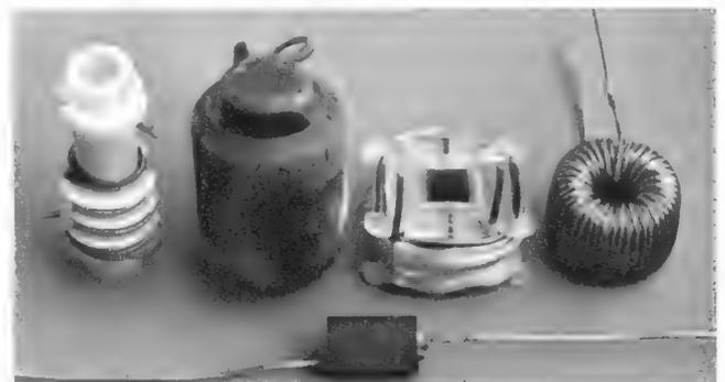
Bild 16. Hf-Siebdrosseln für Lautsprecherausgänge. Von l. n. r.: Grundig, Loewe Opta, Graetz/Schaub-Lorenz, Saba. Vorn: Ferroxcube-Breitbanddrossel von Valvo
