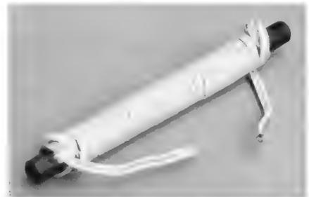
Bild 20. Hf-Lautsprecherdrossel von Grundig
