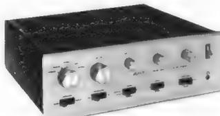
**SCA 80 Q, integrierter Vor- u. Endverstärker**, leistungsstark an 2x 40 W Ausgangsleistung an 8 Ω, 2x 60 W an 4 Ω, Leistungsbandbreite von 8 Hz bis 50 kHz bei einem Klirrfaktor von 0,5 % bei Vollaussteuerung, Klangregelnetzwerk ± 12 dB, Bässe und Höhen getrennt regelbar, Kopfhörerausgang 8 Ω oder höher.
