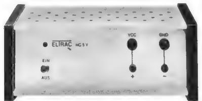
**Stabilisiertes Netzgerät NG, 5 V/2 A**
