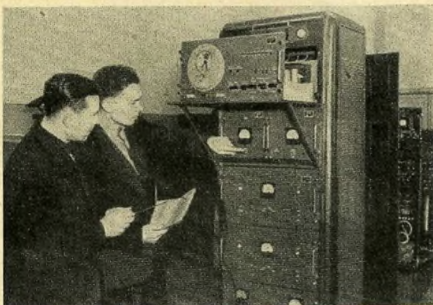
Bild 1: Der Mechaniker der Versuchsabteilung, G. KUKOLEW, und der Radiomechaniker der Gerätemontageabteilung eines Moskauer Werkes, D. D. GOLUDEW, am Schaltpult eines kubischen Teleskops, mit dem die Intensität der kosmischen Ausstrahlung registriert wird.
