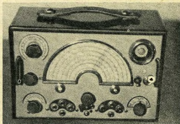
Bild 3: Einen 10-Röhren-Super für die DX-Bänder 10 m und 15 m zeigte YO 2 – 414.
