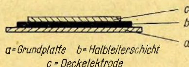
Bild 1: Grundsätzlicher Aufbau des Sperrschicht-Gleichrichters.
