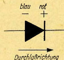
Bild 3: Schaltsymbol und Polung des Sperrschicht-Gleichrichters.
