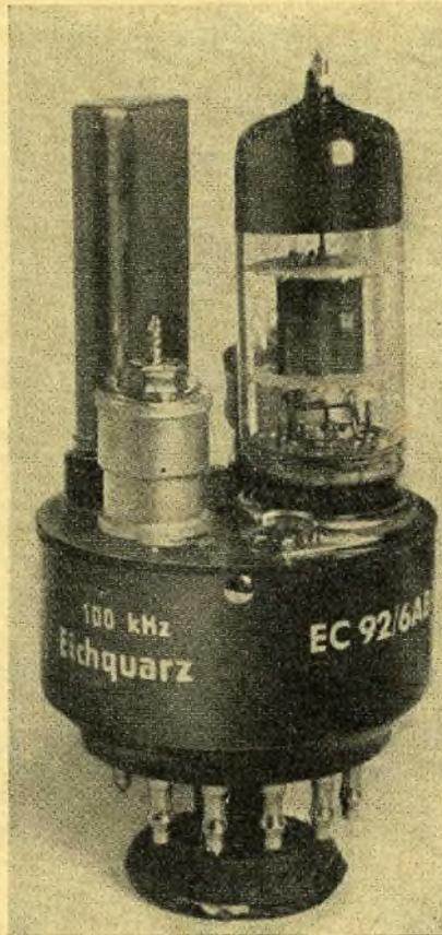
**Ansicht des Quarz-Eichpunktgebers, der als steckbare Einheit ausgeführt ist.**
