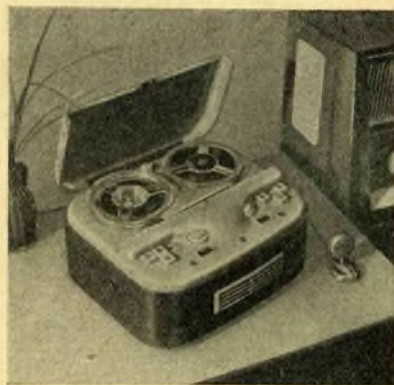
Die neue Ausführung des Tonbandgerätes „KB 100 II“ besitzt einen aufsteckbaren Kombikopf „Multioktav“. Das „KB 100 II“ besitzt u. a. eine getrennte Höhen- und Tiefenregelung und ist umschaltbar auf die Geschwindigkeit 9,5 und 4,75 cm/S.
