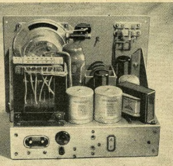
Bild 6: Auf dem Chassis erkennt man die Anordnung der einzelnen Bauelemente. An der Frontplatte erkennt man rechts oben die Buchsen für Antenne und Erde und links den Umschalter für den Lautsprecher.
