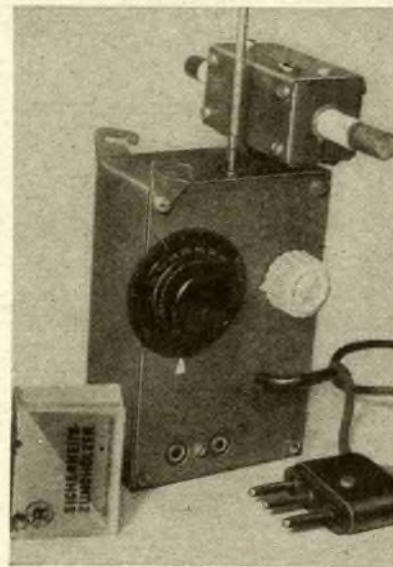
Bild 1: Ansicht des beschriebenen kleinen Fuchsjagdpeilempfängers mit getrennter Stromversorgung
