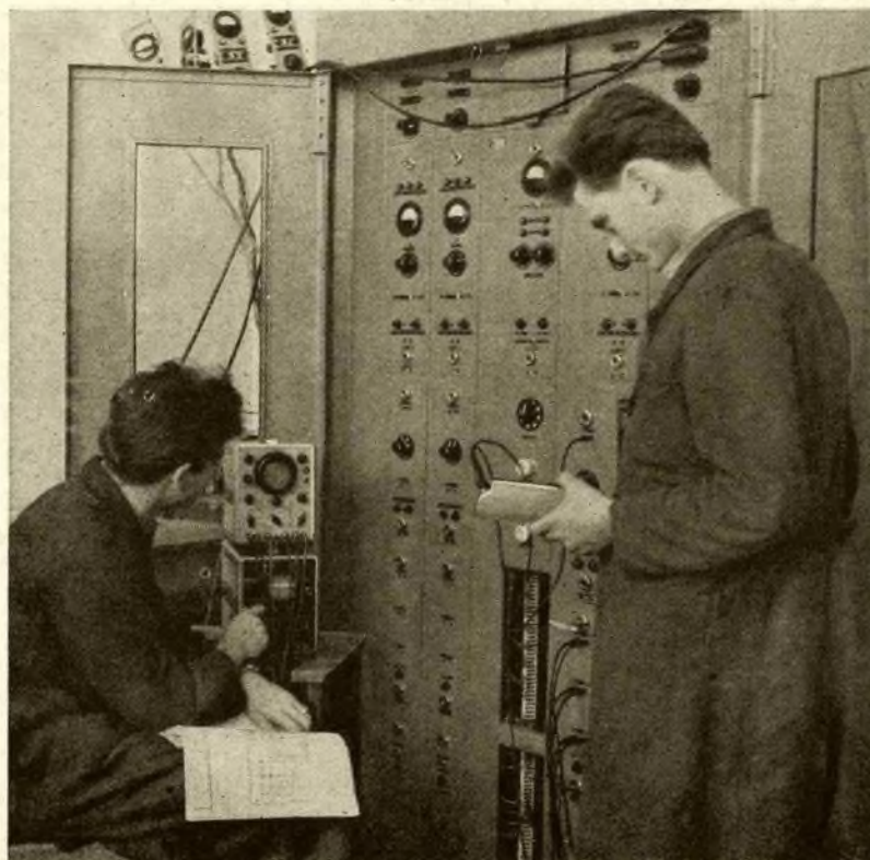
Durch den Bau neuer Werkhallen wird die Produktionskapazität des VEB INTRON, Werk für industrielle Elektronik, Leipzig, erweitert, so daß innerhalb des Siebenjahrplanes die Produktion verzehnfacht werden kann. Auf dem Bild die Endprüfung einer elektronischen Register-Regelanlage (unten)
