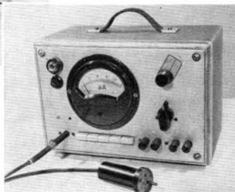
Antennen-Anpaßgerät (Collins) für alle KW-Amateurbänder des Kam. Kästner, Leipzig
