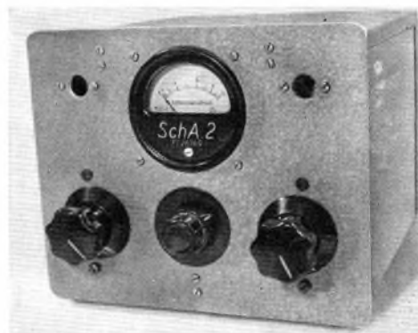
Frequenzmesser, abstimbar und mit kristallgesteuerten Frequenzen, des Kam. Kranke, Böhlen (Bild unten links)
