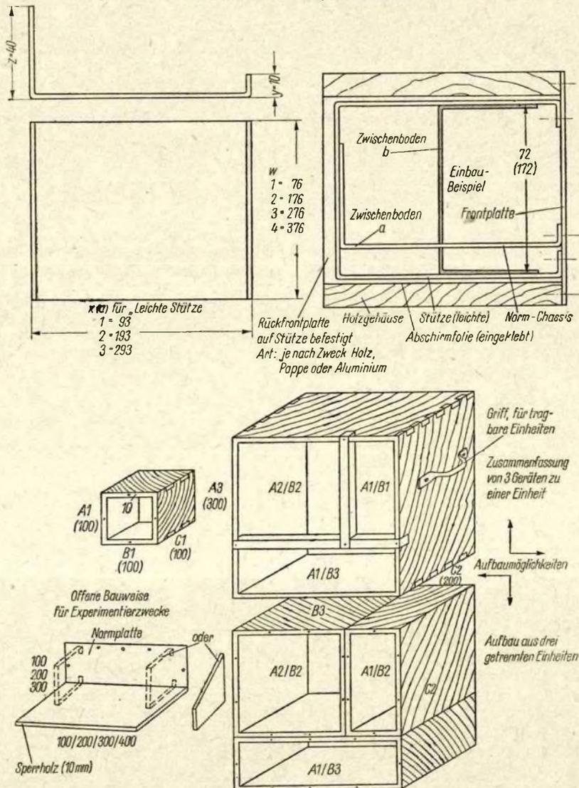
**Bild 8:** Offene Bauweise für Experimentierzwecke und Holzgehäuse für dekadische Normchassis in Einzelausführung oder kombiniert in einem Holzgehäuse
