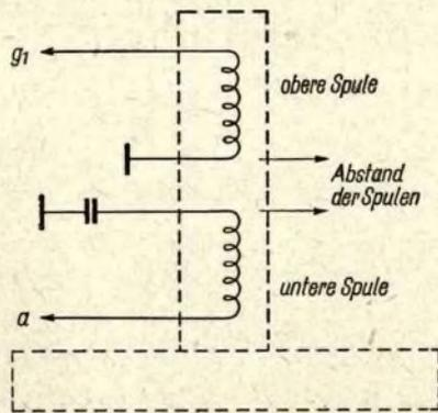
Bild 2: Ausführung der beiden Wicklungen auf dem Spulenträger
