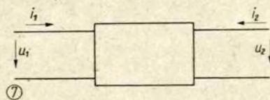
Ströme, Spannungen und Widerstände bei der als Beispiel benutzten T-Schaltung (Bild 5); Abschlußwiderstände des Vierpols (Bild 6) und Vierpoldarstellung des Transistors (Bild 7)
