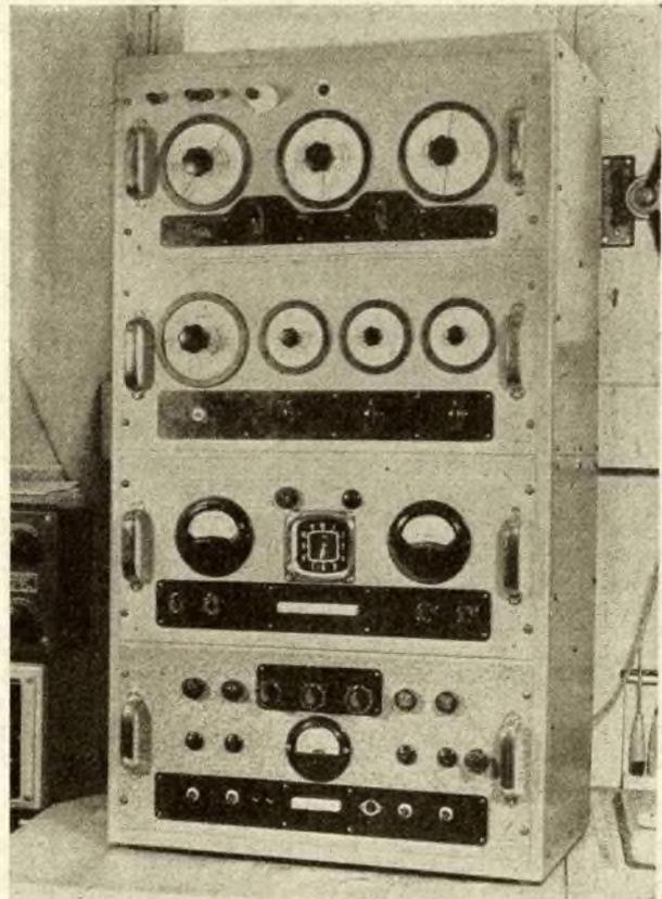
Bild 1: Ansicht des beschriebenen 200-W-KW-Senders. Er enthält von unten nach oben folgende Einschübe: Netzteil - Modulator - Steuerstufen - Treiber- und PA-Stufe
