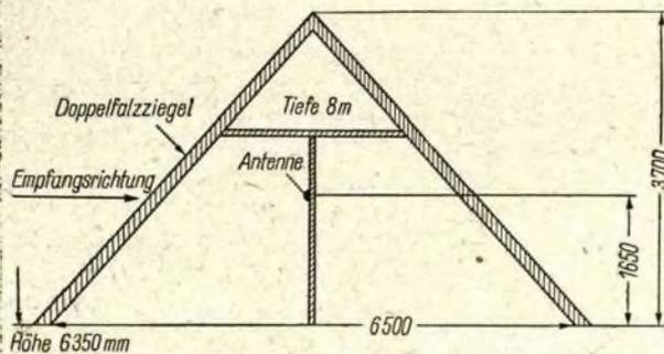
Bild 2: Meßbedingungen für die Dämpfungskurve gemäß Bild 1
