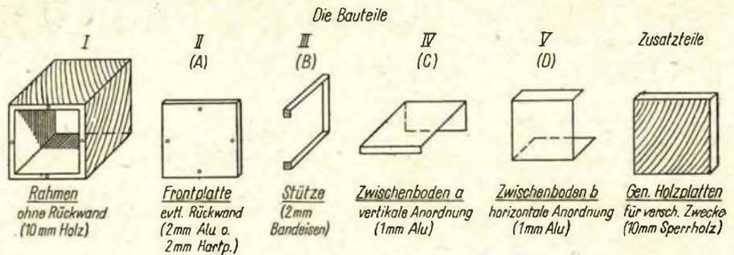
**Bild 2:** Rastersystem (Frontplatten) der dekadischen Amateurnorm. Die rechteckigen Frontplatten können waagrecht oder senkrecht verwendet werden
