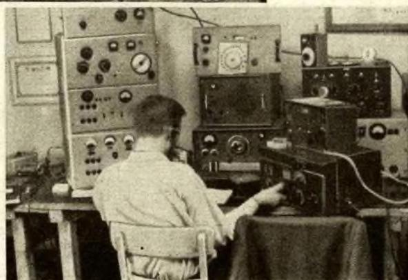
An der kleinen Station (100 W) arbeitet DM 3 KBM. Gehört wird mit einem „Köln“. Darüber steht der 10-m-Empfänger und über dem AOST steht der 10-m-Sender
