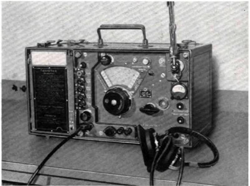
Das Bild rechts oben zeigt den Funkempfänger der Nationalen Volksarmee vom Typ R 311. Er arbeitet im Bereich 1,0 bis 15,0 MHz. Das Frequenzband ist in fünf Grobstufen unterteilt. Der Empfänger R 311 findet in allen Waffengattungen Verwendung. Er arbeitet in A 1- und A 3-Betrieb
