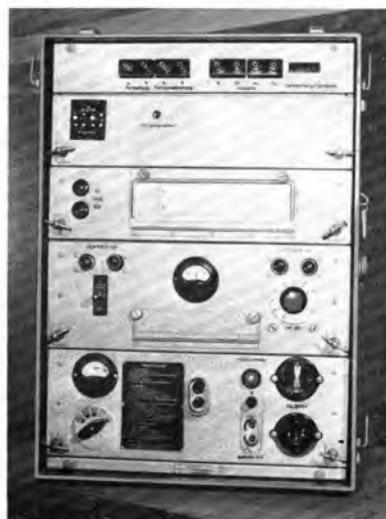
Das Bild links außen zeigt ein Fernschreibanschlußgerät der Nationalen Volksarmee (FSA). Es ermöglicht Umsetzungen von zwei-Draht-Einfachstrom auf vier-Draht-Doppelstrom und umgekehrt; von zwei-Draht-Einfachstrom auf zwei-Draht-Impulstelegrafie und von vier-Draht-Doppelstrom auf zwei-Draht-Impulstelegrafie. Beim Übungsbetrieb können zusätzlich zwei FS-Maschinen angeschlossen werden
