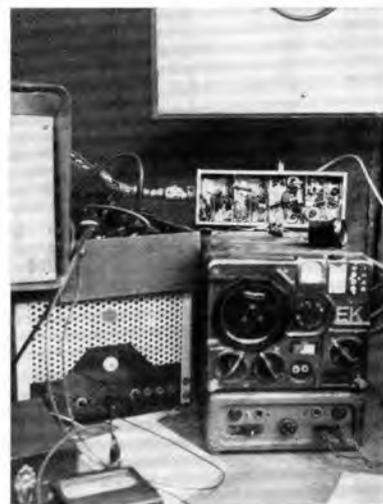
Bei OK 1 KEP wird ein kristallgesteuerter 2-m-Konverter verwendet, dem der Empfänger „EK“ nachgesetzt wird. Eingebürgert hat es sich, an einem Konverter zwei Nachsetzer zu betreiben
