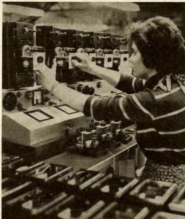
Die Mechanikerin Dorit Mattner prüft Relais vom Typ RZlw 3. Bei diesem Gerät wurde durch die neue Technologie eine Steigerung der Arbeitsproduktivität um 235 Prozent erreicht. Fünf Geräte kann Dorit jetzt gleichzeitig zum Eichen anschließen, früher mußte jedes einzeln geprüft werden. Foto: ZB
