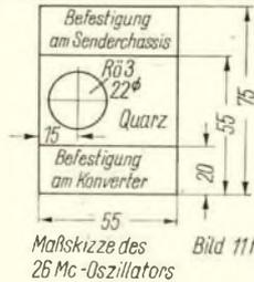
Maßskizze des 26 Mc-Oszillators Bild 11f
