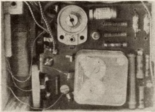
Bild 9: Das komplette Reflexaudion mit P2 im Gerät; der NF-Verstärker wurde seitlich herausgenommen
