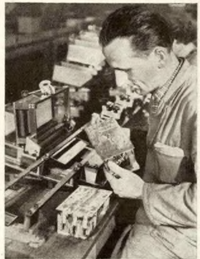
Mit einer eigens für diesen Zweck konstruierten Maschine werden die auf der Plattenunterseite hervorstehenden Anschlußenden einheitlich auf 3 mm Länge gekürzt. Wie der Bart des Mechanikers zeigt, eignet sich diese Konstruktion noch nicht zum Rasieren
