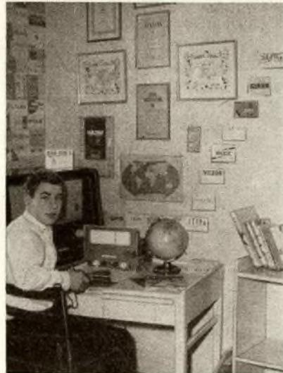
Der O-V-2 mit linearer Skala arbeitet von 15 m bis 80 m. Als Antenne wird ein Multi-Band-Dipol nach G 5 RV verwendet, der sich besonders auf 15 m und 40 m auszeichnet. Links neben dem O-V-2 steht ein BCRX-SH 11, der nur bei Contesten auf dem 40-m-Band Verwendung findet.
