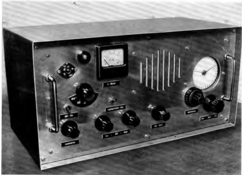
Bild 1: Vorderansicht des Amateur-Doppelsupers für alle KW-Bänder. Die Frontplatte ist sehr stabil ausgeführt. Die gravierten Beschriftungsschilder geben dem ganzen Empfänger fast ein kommerzielles Aussehen
