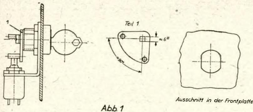
sein muß. Hier ist dieses Teil so dargestellt, daß sich der Schlüssel nur in einer Schalterstellung abziehen läßt. Soll er auch in eingeschaltetem Zustand abziehbar sein, so müssen die Zapfen, die den Schaltknebel bewegen, einen Winkel von etwa 180° statt 90° einschließen.
