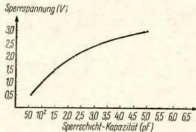
einer Änderung der Sperrspannung um 1 V tritt eine Kapazitätsänderung von rund 120 pF auf. Dieser Wert ist sehr gut reproduzierbar, so daß die nachfolgend näher erläuterte Schaltung entwickelt wurde.
