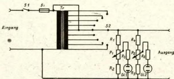
**Schaltung des beschriebenen Regeltrafos mit der Anzeigeeinrichtung**
