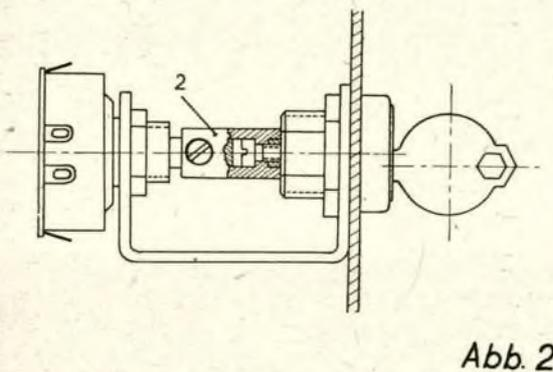
Bild 1: Kombination des Schloßes mit einem Kippschalter
