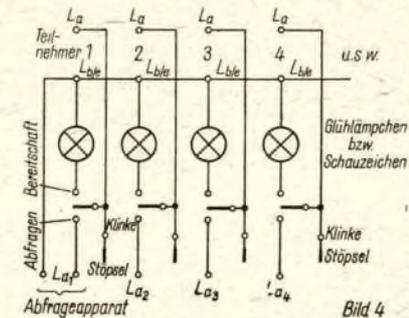
Bild 4: Schaltbild einer einfachen Vermittlung für den Betrieb mit mehreren Taschentelefonen
