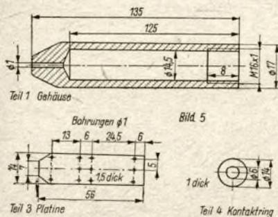
**Bild 5:** Maßskizzen für die wichtigsten mechanischen Bauteile
