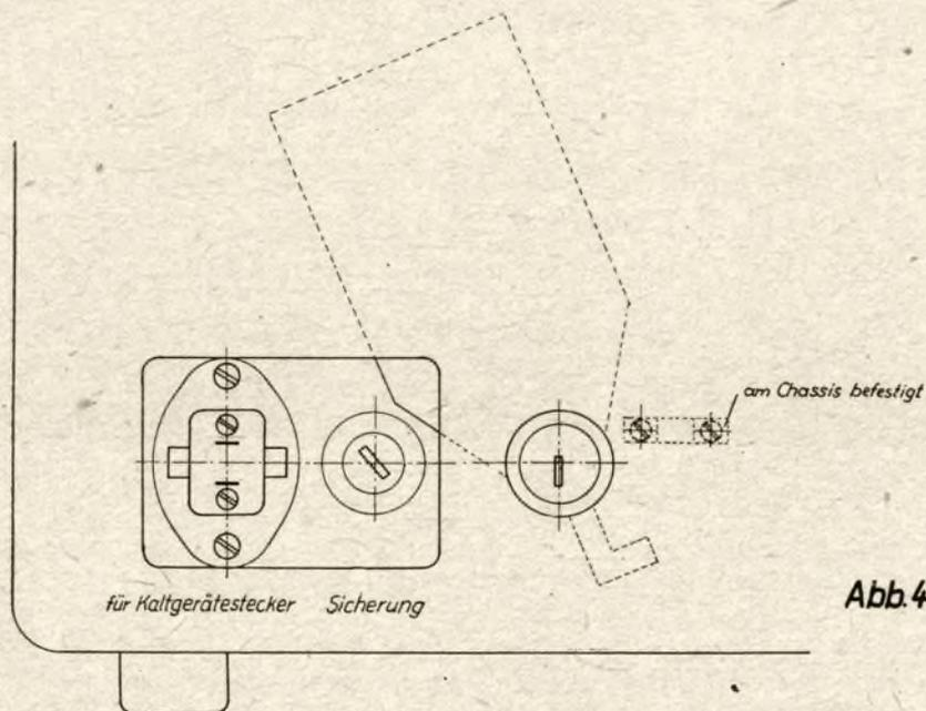
**Bild 4:** Kombination des Schlosses zur Abdeckung von Sicherung und Gerätesteckerbuchse an der Gehäuserückseite
