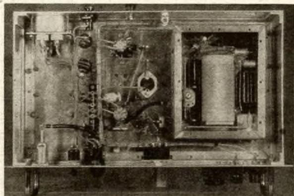
Bild 6: Blick von oben auf den VFX-Einschub. Der Abschirmkasten des VFO ist geöffnet
