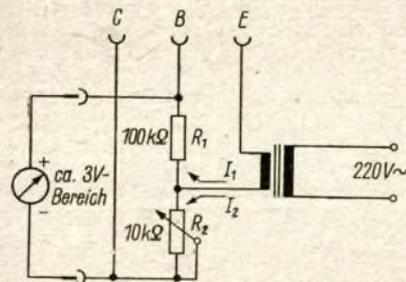
Schaltung der einfachen Transistor-Prüfeinrichtung
