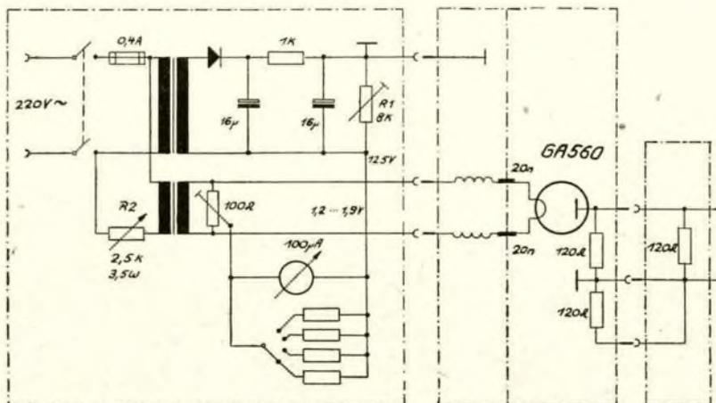
Drahtdrehregler wurde mit einer Rückstellfeder versehen, damit die Diode nur zum unmittelbaren Meßvorgang aufgeheizt wird. Die Diode besitzt nur eine sehr geringe Betriebsdauer. Mit dem 100- $\mu$ A-Drehspulinstrument wird der Diodenstrom gemessen. Durch Shunts wurden vier Bereiche eingeteilt. Die Strombereiche sind so festgelegt, daß an der Skala unmittelbar die Grenzempfindlichkeit ablesbar ist. Die erforderlichen Strommeßbereiche werden nach der Formel:
