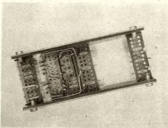
Bild 6: R- und C-Meßbrücke in Baugruppenteknik
