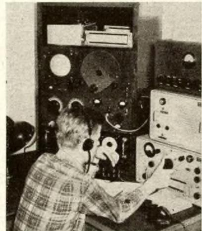
Links unten erkennt man das Sendernetzteil und den 0-V-2. Darüber steht der TX; der oberste Einschub ist ein Rundfunksuper. Der Sender hat drei Stufen (Eco-Bu-Pa); die PA ist mit einer EL 12 spez. bestückt, die 700 V Anodenspannung erhält. Input etwa 50 W. Moduliert wird Anode und Gitter 2 mittels MV 23. Der MV steht rechts oben, darunter der AQST. Die Antenne ist eine Art Windom, 41,6 Meter lang.
