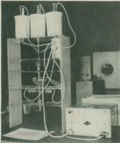
Bild 5: Vollautomatisch kann man mit diesem Gerät Fotofilme entwickeln. Die Zu- und Abfuhr der Flüssigkeiten wird mit Relais über einen Zeitschalter ermöglicht
