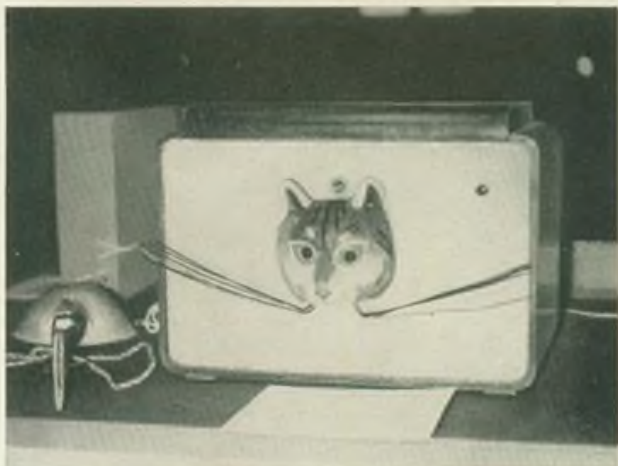
Bild 5: Das Verhalten von Katzenaugen bei Helligkeit und bei Dunkelheit kann mit diesem kybernetischen Gerät dargestellt werden
