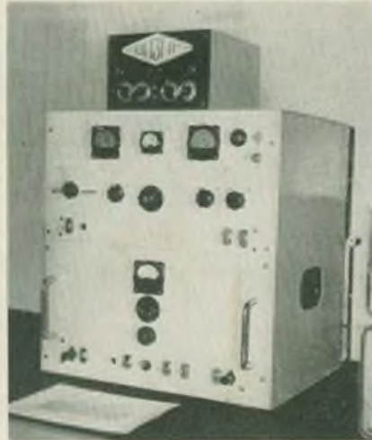
Bild 7: Der Sender von UW 3 NF arbeitet auf allen KW-Amateurbändern. Betrieben werden kann er in AM und CW
