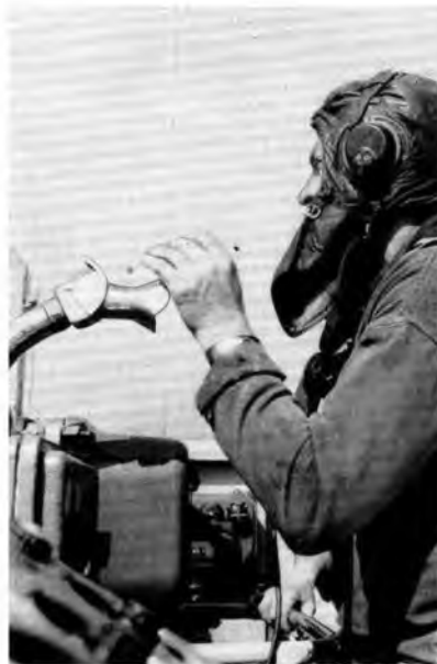
Auf jedem Schiff als Telefon oder Reserve-Nachrichtsmittel zu finden: das Sprachrohr
