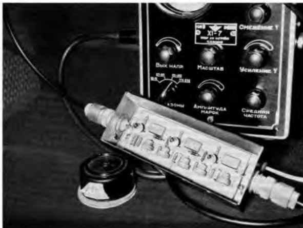
Bild 6: Unser Bild zeigt einen mit Halbleiter-Bauteilen bestückten Antennenverstärker, wie er z. B. für Weitempfängerversuche beim Fernsehen verwendet werden kann
