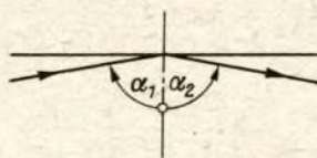
Bild 6: Entstehung der Totalreflexion bei einer Grenzschicht mit n_2 kleiner als n_1
