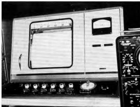
Bild 2: Von einem Kollektiv entwickelt wurde dieser Kennlinienschreiber für Tunneldioden. Für die angeschlossene Tunneldiode werden die Parameter eingestellt und dann selbsttätig der Kennlinienverlauf aufgezeichnet
