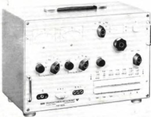
**Bild 2:** Das volltransistorisierte Transistormeißgerät Typ 1029 ermöglicht die Messungen der  $\gamma$ - und  $h$ -Parameter von Transistoren mit einer Meßfrequenz von 800 Hz. Meßbar sind npn- und pnp-Typen. Durch Drucktastenschalter ist die Bedienung gegenüber dem Vorläufer Typ 1014 wesentlich erleichtert. Es lassen sich Kollektorspannungen bis 30 V und Kollektorströme bis 30 mA einstellen und messen (links Mitte)
