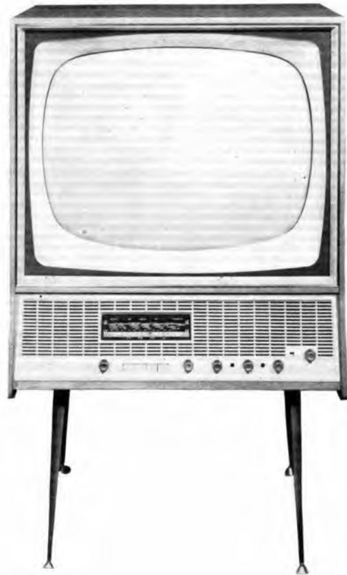
Eine Neuentwicklung ist auch das kombinierte Standgerät „Forum super 16“, das das neue Fs-Chassis „Dürer de luxe“ und das Rundfunkchassis „Jalta“ enthält. Das Fs-Teil benutzt im ZF-Verstärker zwei Spanngitterröhren EF 183, als Netzgleichrichter wird eine Siliziumdiode verwendet (VEB Rafena-Werke Radeberg)
