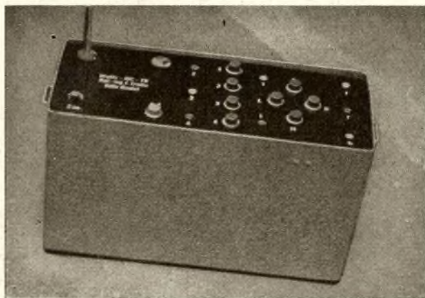
Bild 19: Mehrkanal-Tastgerät für eine 8-Kanal-Schiffsmodell-Fernlenkanlage
