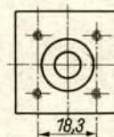
Bild 1: Prinzipaufbau des Antennen-Umschaltrelais und Maßskizze für die Blattfeder
