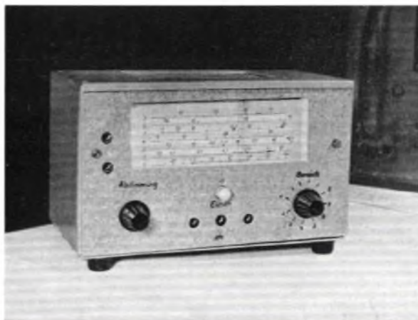
Wolfram v. d. Aa entwickelte dieses netzbetriebene Röhrevoltmeter mit symmetrischem und unsymmetrischem hochohmigen Eingang, sowie Strommesser. Zur Anzeige dient ein 100 \mu A-Instrument. Nullpunkt und Vollausschlag sind getrennt eichbar (rechts)
