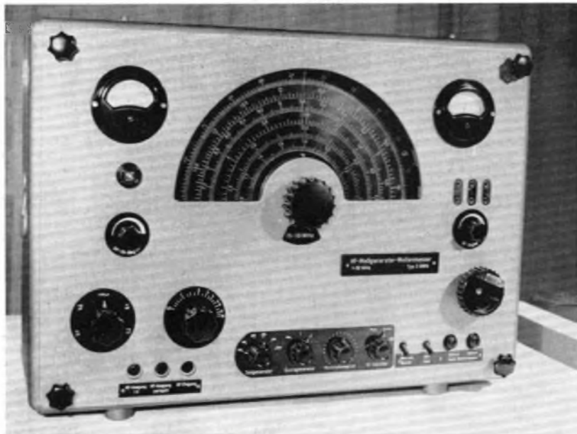
Der Rundfunkmechanikermeister August Müller, DM 2 AWO, stellte einen Meßsender-Wellenmesser vor. Das Gerät dient zur aktiven und passiven Frequenzmessung an HF-Geräten im Frequenzbereich zwischen 1 MHz und 30 MHz. Im Falle der aktiven Messung kann das Signal mittels eines eingebauten Tongenerators mit 5 verschiedenen Tonfrequenzen moduliert werden. Der Modulationsgrad ist einstellbar. Ein eingebauter Quarzoszillator dient zum Eichen des Gerätes. Dieses Gerät wurde vom OM Müller als Meisterstück angefertigt (links)
