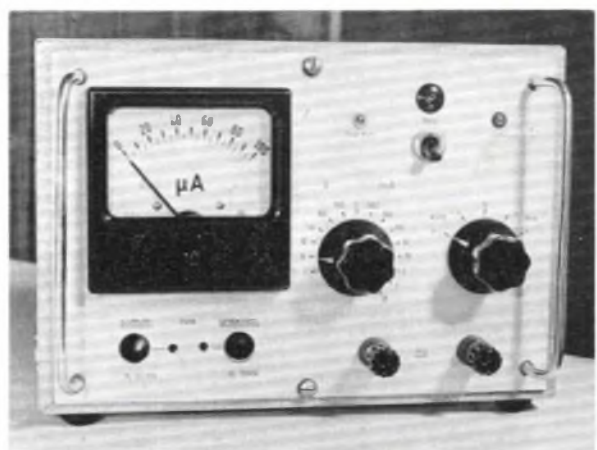
HF-Prüfgenerator ausgestellt von Ullrich Kuphal. Dieses kleine handliche Gerät erlaubt den Bereich zwischen 3,5 MHz und 80 MHz, der in 7 Teilbereiche unterteilt ist. Zur Eichung ist ein 7 MHz-Quarz eingebaut. Durch einen eingebauten Glühlampengenerator kann das Signal AM moduliert werden. Röhrenbestückung: 2 \times ECC 82, 1 \times UR 110 (links) Foto: MBD Demme
