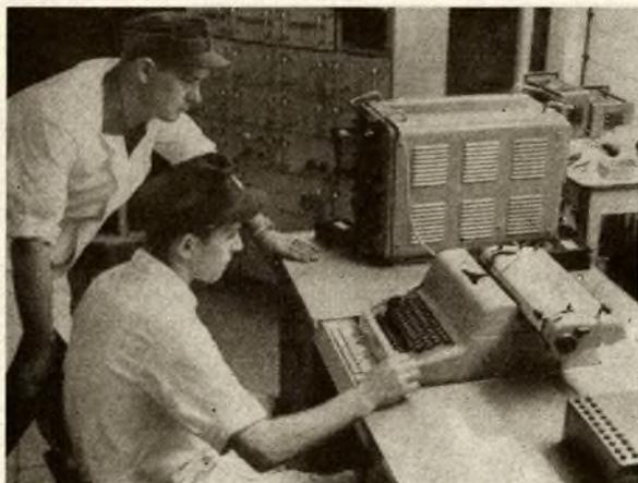
**Bild 1 (oben):** Nach mehrmonatiger Erprobung ist jetzt das erste Konstruktionsmuster des elektronischen Kleinstrechenautomaten D4a vom Institut für maschinelle Rechentechnik der TU Dresden ausgeliefert worden. Nicht größer als ein Tischfernsehgerät entspricht die rechnerische Leistung dem Zeiss-Rechner ZRA 1
