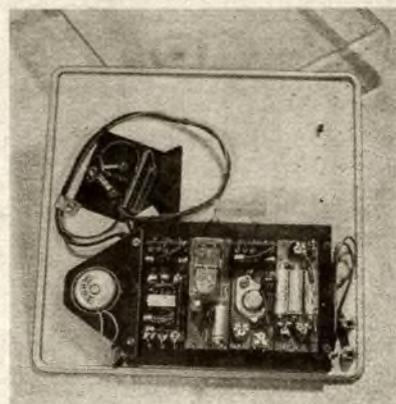
Bild 2: Auf einer Perminox-Grundplatte sind die Kontaktfedern aus Drahtstücken angeordnet, in die die Stifte der Baugruppen eingesteckt werden
