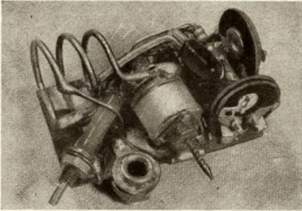
**Bild 5: Ansicht des Tunneldiodensenders nach Bild 3**
