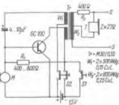
Um eine noch größere Leistung zu ermöglichen, wäre es notwendig, einen weiteren Transistor über RC- oder Transformator-Kopplung anzuschließen.
