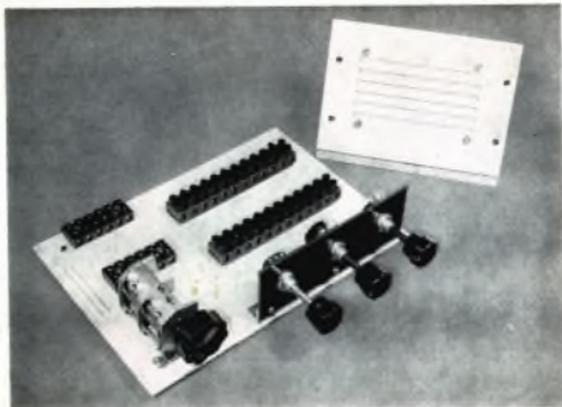
Auf eine Preßspanplatte aufgebaut ist ein Transistor - Experimentierbrett zum Ausprobieren von einfachen Empfängerschaltungen. Die elektrischen Verbindungen erfolgen über Klemmleisten. Der Kleinausgredner ist mit dem Ausgangsübertrager getrennt aufgebaut. Mustergerät: K.-H. Schubert - DM 2 AXE (Bild oben)
