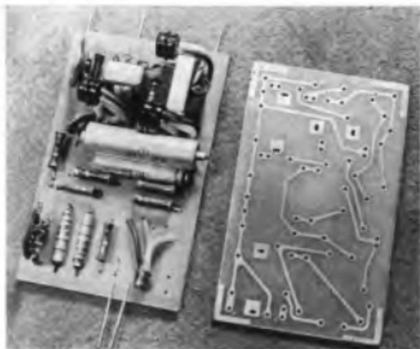
Im gedruckter Schaltungstechnik wurde dieser NF-Universalverstärker nach D. Beilmann aufgebaut. Die Ausgangsleistung ist etwa 300 mW, die Eingangsspannung etwa 50 mV. Die Betriebsspannung kann zwischen 4,5 und 9 V liegen. Eine genaue Bauanleitung findet man im Heft 11 1966 der Zeitschrift „radio und fernsehen“. Mustergerät: J. Badelt - DM 3 WWO
