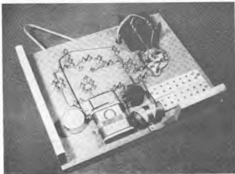
Der gemessene Transistor hat also einen Stromverstärkungsfaktor von 60. Man kann diese Messung auch mit anderen Spannungs- und Widerstandswerten durchführen. Den Basisstrom ermittelt man mit obiger Formel.
