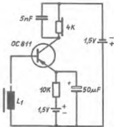
Bild 3: Einstufiger Hörverstärker mit Hörspeule
