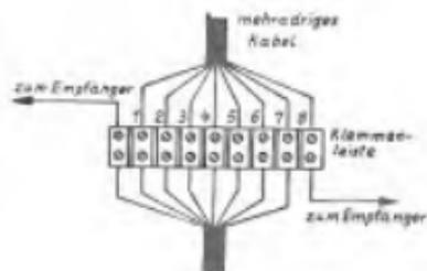
Bild 2: Mehradriges Kabel als Spule geschaltet
