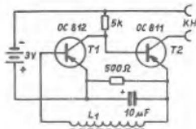
Bild 4: Einfacher zweistufiger Hörverstärker
