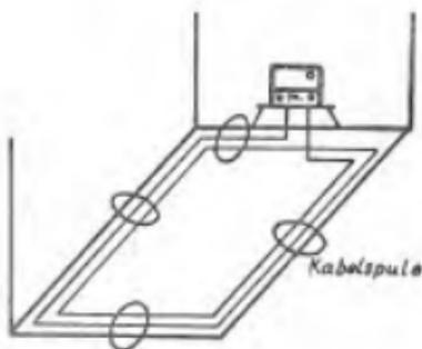
Bild 1: Prinzipdarstellung der Mörschleife
