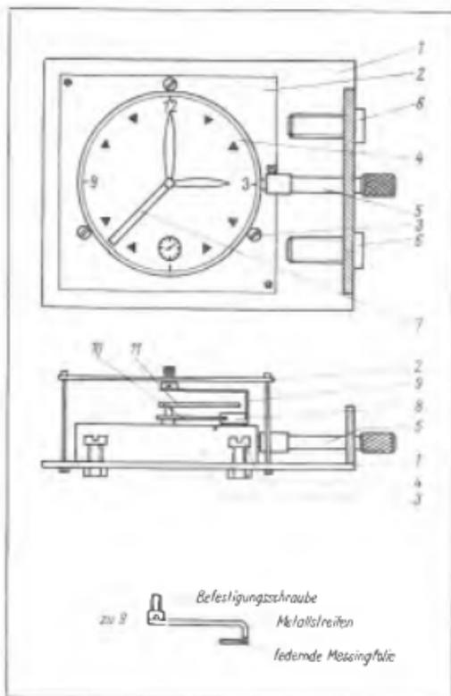
Bild 1: Prinzipskizze der Schaltuhr. Grundplatte (1), Plexiglasplatte (2), Befestigungsschrauben (3), Armbanduhr (4), Kranz-Verlängerung (5), Steckbuchsen (6), Stellszeiger (7), federnde Messingfolie (8), Form des Stellszeigers (9), Stundenzeiger (10), Minutenzeiger (11). Gehäuseabmessungen 60 x 25 mm (links)
