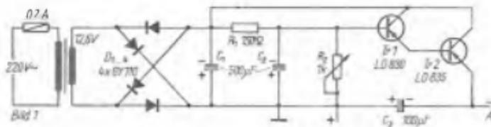
Bild 1: Schaltung des stabilisierten Netzteil
