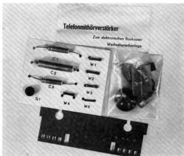
Bild 4: Wahlweise kann auch für das Emp- fangsteil ein Telefon-Mithörverstärker in die Hauptstelle eingebaut werden, um ank- ommende Telefongespräche lautstark wiedergeben zu können
