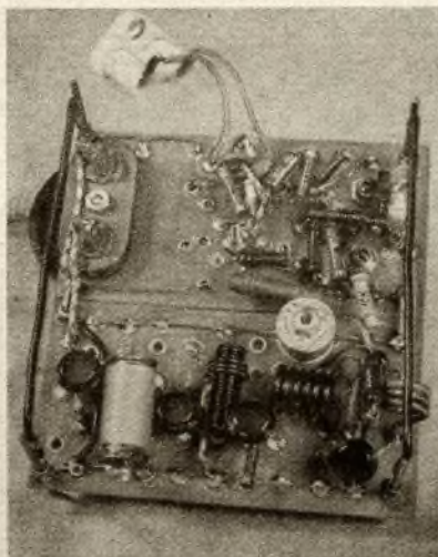
Bild 5: Schaltung zum Nachweis der Oszillatorfrequenz von 132 MHz
