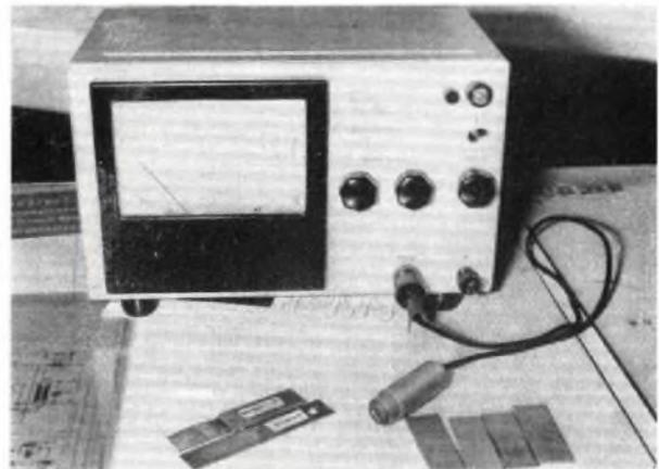
Der Klub Junger Techniker im VEB Fernsehgerätekombi Staßfurt baute für die Sternwarte der Oberschule Halle-Kanena einen Zeitzeicheneempfänger zum Empfang internationaler Zeitzeichen, die zur Synchronisation eines Marine-Chronometers benutzt werden (Bild Mitte links)
