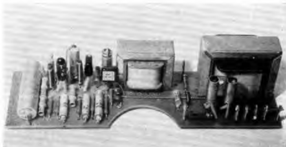
Bild 13: Chassisplatte für den NF-Verstärker mit einer Ausgangsleistung von etwa 1,2 W. Transistorbestückung: OC 603, OC 812, OC 821, 2 x GC 301
