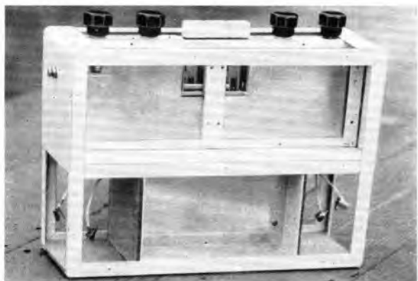
Bild 19: Rückansicht des mechanischen Aufbaus der Kleinstation. Auf dem inneren Rahmen werden die Bausteinplatten befestigt
