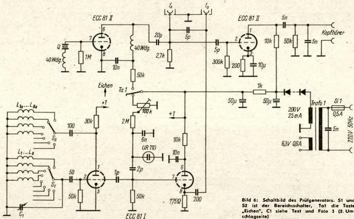
**Bild 6: Schaltbild des Prüfgenerators.** S1 und S2 ist der Bereichsschalter, Ta1 die Taste „Eichen“, C1 siehe Text und Foto 3 (2. Umschlagseite)
