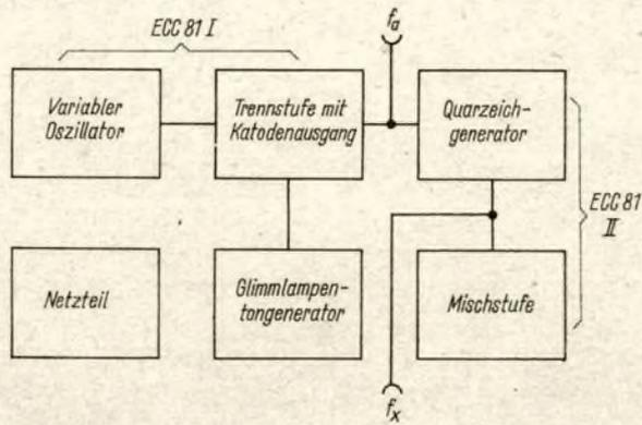
**Bild 5: Blockschaltbild des beschriebenen Prüfgenerators**
