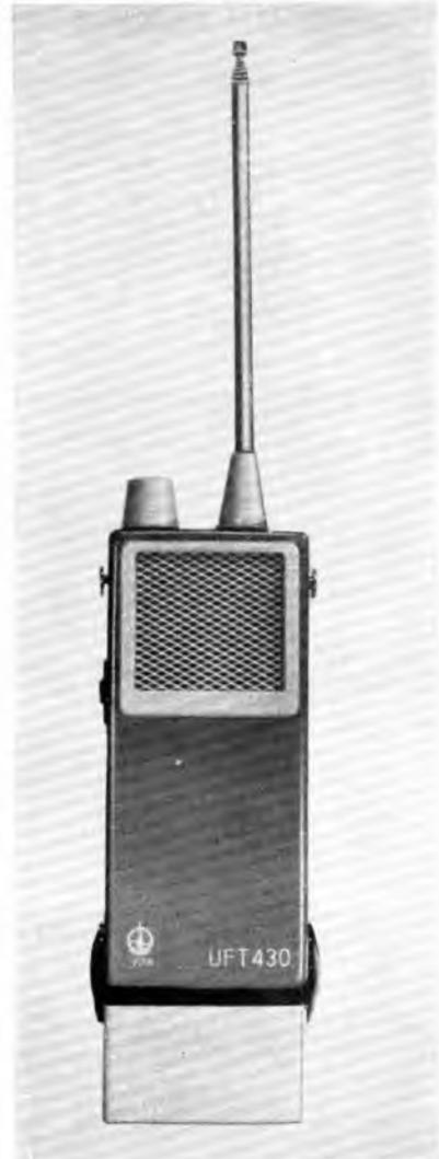
Bild 4: Ansicht des Empfängers (links unten). 16 Informationskanäle stehen im Bereich 70 bis 87,5 MHz zur Verfügung
