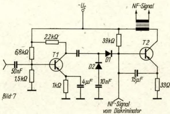
Bild 7: Schaltung für eine elektronische Rauschsperrschleife mit Transistoren
