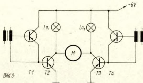
Bild 3: Brückenschaltung zur Steuerung der Rudermaschine
