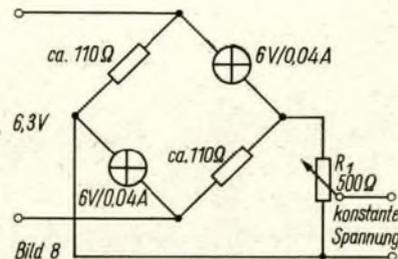
Bild 8: Glühlampenbrücke zur Gewinnung einer hochkonstanten Ausgangsspannung
