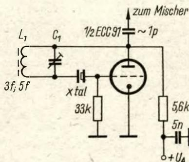
ein Kreis mit hoher Güte, jedoch mit geringer Induktivität. Der geringe induktive Widerstand der Spule L1 bei der Grundfrequenz des Quarzes beeinflusst die Schwingneigung des Quarzes fast nicht.
