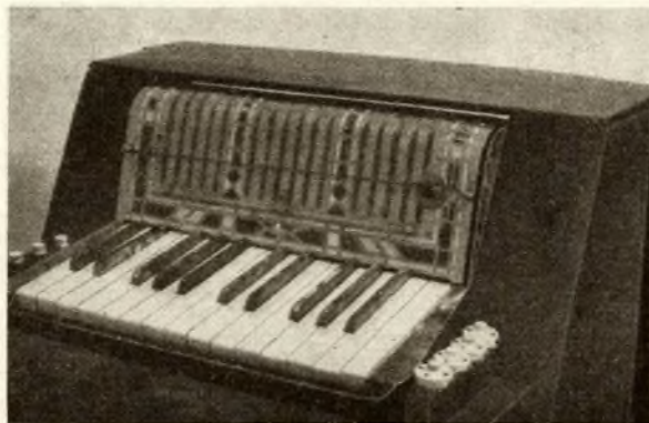
Bild 6: Vorderansicht des beschriebenen Transistor-Harmoniums. Verwendet wurde dafür die Klaviatur eines alten Akkordeons
