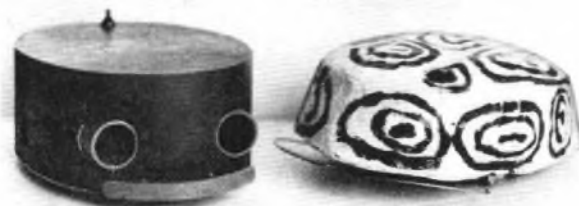
Bild 5: Die Station Junger Techniker und Naturforscher Lauchhammer-Ost stattete ihr Modell „Kybi 1“ mit einem kombinierten Hör- und Tastsinn aus (links). Sehr sauber und mit gedruckter Verdrahtung ausgestattet ist das kybernetische Modell von K.-J. Butz, Hennigsdorf, das auch erweitert wurde.
