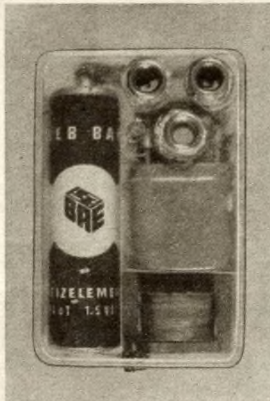
Bild 3: Ansicht des Versuchsmusters. Größe 55 × 35 × 15 mm, links die Monozelle, obere Steckbuchsen: Pol 2-3 (Bild 2), untere Buchse: Pol 1. Rechts Mitte der Quarz, rechts unten Übertrager K 21. Zwischen unterer Buchse und Batterie ist als punktförmiges Bauteil die Tunneliode erkennbar
