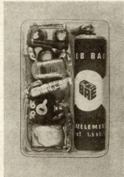
Bild 4: Innenaufbau des Versuchsmusters. Links unten der K-21-Kern, darüber das Potentiometer für Arbeitspunkteinstellung, der 10-μF-Elko, 0,1-μF-Kondensator, zwischen den Buchsen die HF-Drossel. Unter den Kondensatoren liegt der Quarz
