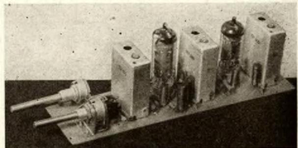
Bild 1: Ansicht der Leiterplatte für das ZF-Teil eines KW-Amateurempfängers
