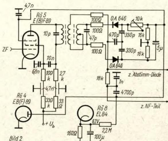
Bild 2: Feldstärkeabhängige Rauschunterdrückung bei FM
