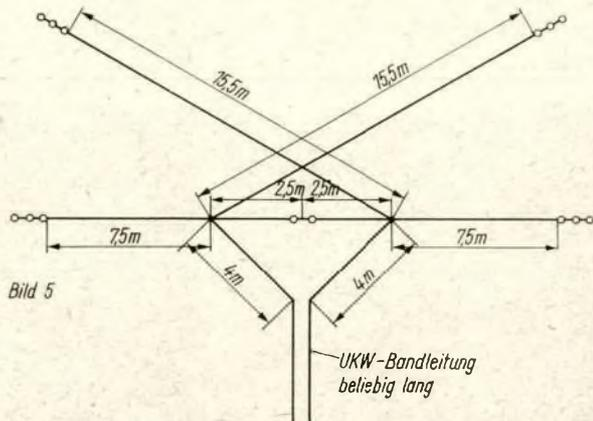
Bild 5: Doppeldipol für 2 ... 26 MHz
