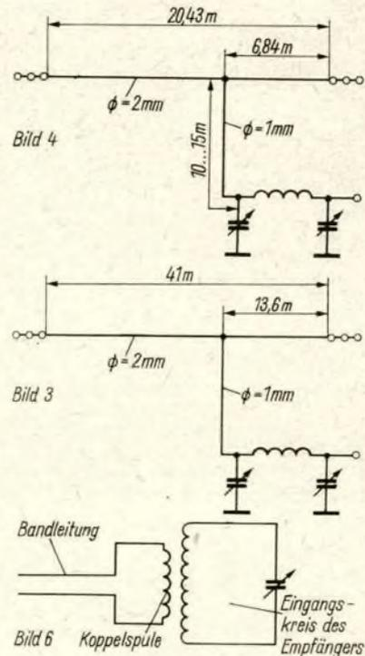
Bild 3: Windomantennen sind für alle KW-Amateurbänder brauchbar
