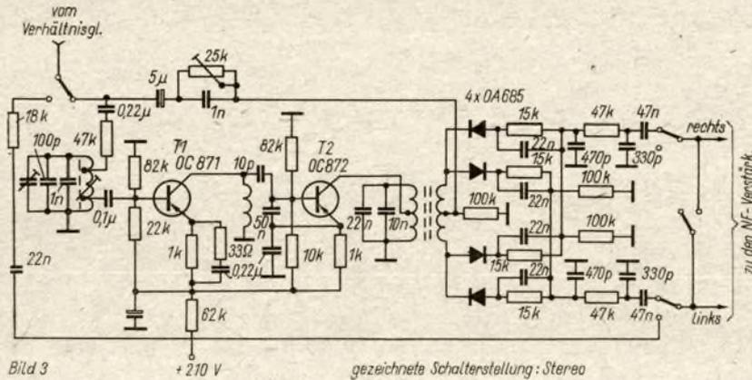
Bild 3: Stereo-Decoderschaltung zur Wiedergewinnung der beiden Stereosignale aus dem Multiplexsignal. (Die Schaltungen stellen vereinfachte Auszüge aus der Originalschaltung des Gerätes „Antonio-Stereo“ dar)
