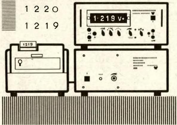
Das Digitalvoltmeter Typ 4013 in Verbindung mit dem Zählbetragdrucker Typ 3510 mißt für Sie automatisch Gleichspannungen zwischen 1mV und 2000 mV mit einer Genauigkeit von 0,05% v. E.
