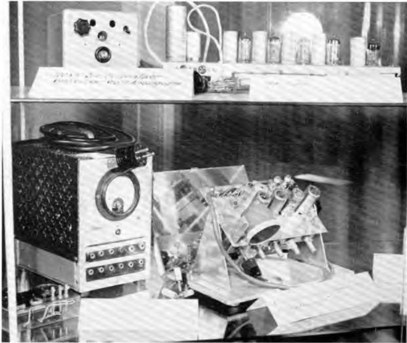
In der Ausstellungs-Vitrine sehen wir von links oben nach rechts unten einen 100-kHz-Quarzeichpunktgeber von Klaus Bils, DM 2 CHO; einen UKW-Super, entstanden in der Station Junger Techniker Berlin-Mitte; ein Transistor-Meßgerät (Berndt Bruhn) und einen NF-Verstärker mit Schaltautomatik und Rückkopplungssperre, konstruiert von dem 67jährigen OM Arthur Krüger, DM 2 CXO (Bild oben)
