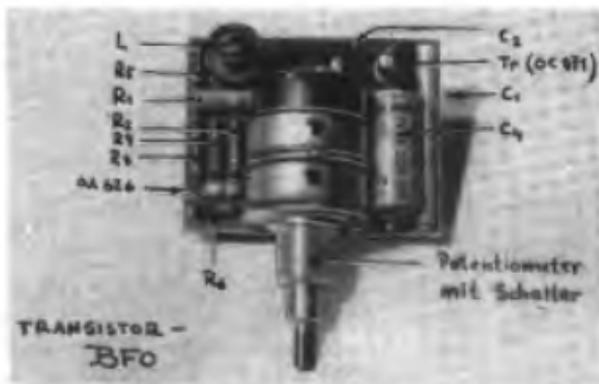
hochfrequenzmäßig an Masse,  $R_3$  ist der Emittierwiderstand und  $R_5$  der Kollektorwiderstand des Transistors.
