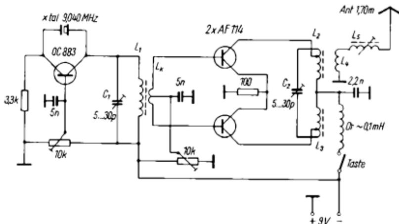
Bild 1: Schaltung des beschriebenen Fernsteuersenders
