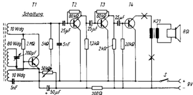
und Kollektor angeordneten Widerstand. Die Eintaktstufe besitzt lediglich einen Vorwiderstand zum Minuspol der Batterie. Der Lautsprecher LP 358 („Sternchen“) oder der kleinere Typ 121 K („Mikki“) wird über den Ausgangsübertrager K21 angeschlossen. Zur Stromversorgung dienen zwei in Reihe geschaltete Flachbatterien oder die raummäßig günstigere, aber im Preis höher liegende „Steraden“-Batterie. Der Aufbau erfolgt auf einer Perlinaxplatte mit Lötlöten.
