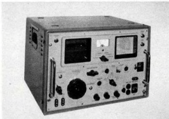
Bild 3: Eine moderne Konzeption zeigt der UKW-Empfänger „VU 21“, der den Bereich von 20 bis 220 MHz erfaßt. Je nach Bereich wird eine zwei- oder dreifache Mischung benutzt. Die Betriebsarten sind A1, A3 und F3
