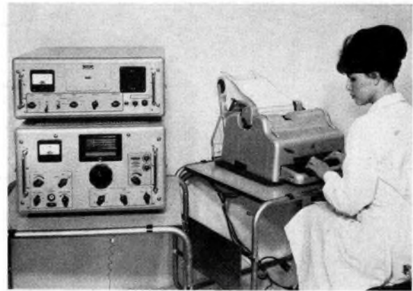
Bild 2: Einen Frequenzbereich von 1,85 bis 25 MHz erfaßt der KW-Empfänger „ML 400“ (unten) mit dem aufgesetzten Funkfernsehzeugsatz. Die erste ZF ist 1,6 MHz, die zweite 78 kHz. Ein Eichoszillator (500 kHz) ist eingebaut
