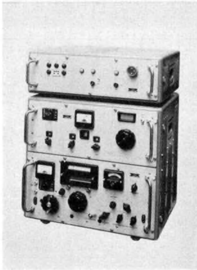
Bild 1: Der Kurzwellen-Empfänger-Satz „ML 1000“ besteht aus einem KW-Empfänger 1,5 bis 30 MHz (unten), einem Frequenzstabilisator für den 1. und 2. Oszillator (Mitte) und der Stromversorgung (oben)
