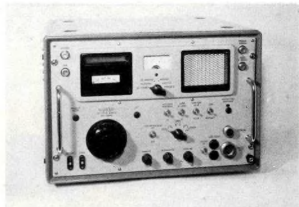
Bild 4: Für noch höhere Frequenzbereiche steht der VHF-Empfänger „VU 31“ zur Verfügung (200 bis 460 MHz). Die Zwischenfrequenzen sind 52,7 MHz – 16,32 MHz – 5,25 MHz – 1,56 MHz. Bestückt ist der Empfänger mit 24 Röhren
