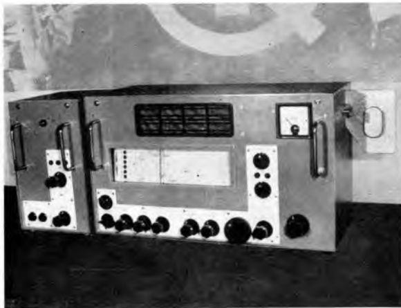
Bild 2: Dieser Doppelsuper mit getrennter Stromversorgung umfaßt in 6 Bereichen Frequenzen von 1,4 bis 30 MHz. Konstruiert wurde das Gerät von Kam. K. Janson, DM 3 MO
