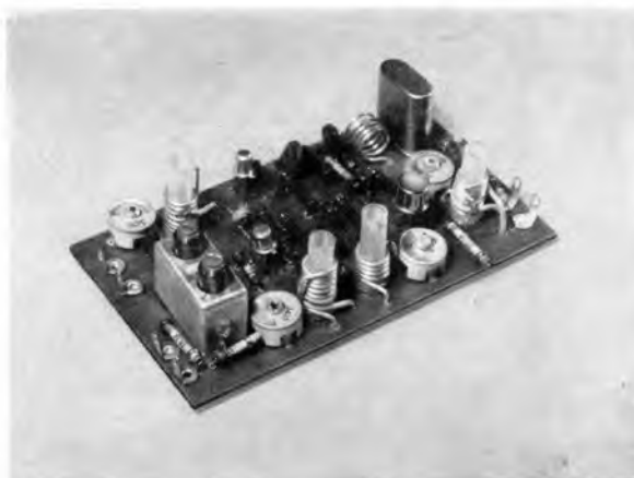
Bild 4: Das ist der neue 2-m-Konverter, den Kam. L. Fischer, DM 2 ARE, mit Transistoren des HFO konstruierte. Die Schaltung entspricht etwa der Ausführung im Heft 11/1966
