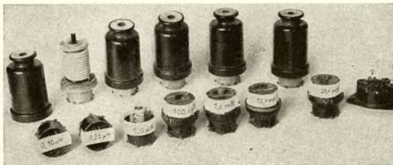
Bild 5: Verschiedene selbst hergestellte Induktivitätsnormale zur Eichkontrolle des L-Meßteils
