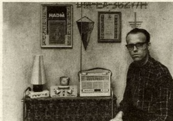
Das Foto zeigt die „Mini“-Empfangsstation von DM-EA-3627/H. Von links nach rechts: Netzteil, Collins-Filter, RX „Spatz-baby“
