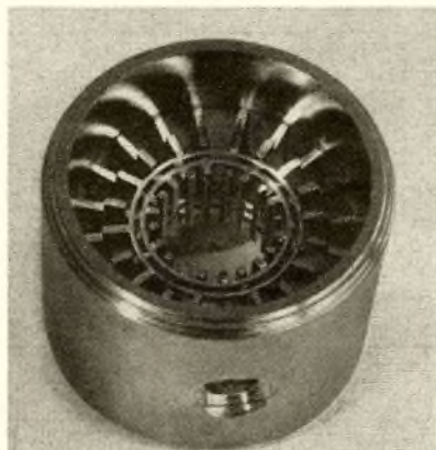
Bild 3: Resonator eines Dauerstrichmagnetrons
