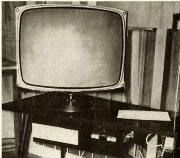
**Bild 6:** Dieser Eigenbau-Fs-Empfänger mit Fernsteuerung von K. J. Samoulikow enthält die Schaltung im Tisch eingebaut, auf dem drehbar die Bildröhre angeordnet ist
