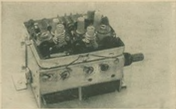
Standardisierter UKW-Transistortuner Typ 3. Dieser Tuner ist mit zwei Transistoren bestückt und wird mit (AM) FM-Doppeldrehkondensator abgestimmt. Er ist universell einsetzbar. Deshalb gibt es 12 Hauptvarianten. (Jugendkollektiv im VEB Antennenwerke Bad Blankenburg)
