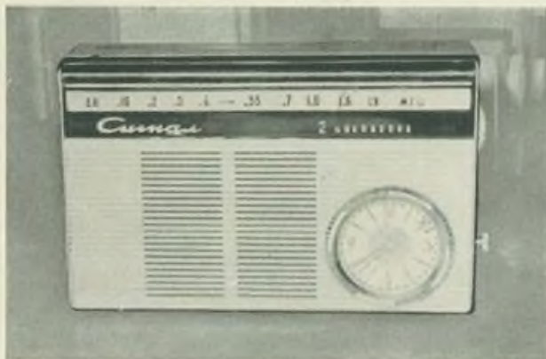
Bild 4: Als „tönendes Notizbuch“ bezeichnet wird der mit einem Notizblock kombinierte Transistorsuper „Sjurpris“ (Überraschung), MW, 6 Transistoren, 5 Kreise, 135 mm × 85 mm × 15 mm
