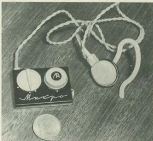
Bild 5: Der kleinste Transistorempfänger ist der „Mikro“, dessen Schaltung in Dickfilmtchnik ausgelöhrt ist. MW und LW, 43 mm × 30 mm × 7,5 mm, 27 g. Der Empfänger arbeitet in Geradeausschaltung mit 4 HF- und 2 NF-Stufen Fotos: MBD Hein
