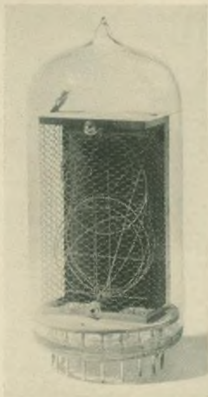
Bild 3: Die Ziffernanzeigeröhren vom Typ Z 568 M haben 50 mm hohe Ziffern, sie eignen sich vor allem für Großsichtanlagen
