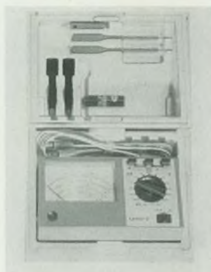
Bild 5: Modern gestaltet ist das Universalmeßgerät „Lavo-3“ der Firma LUMEL mit 20 kOhm V. Gemessen werden können Spannungen und Ströme bei Gleich- und Wechselstrom sowie auch Widerstände
