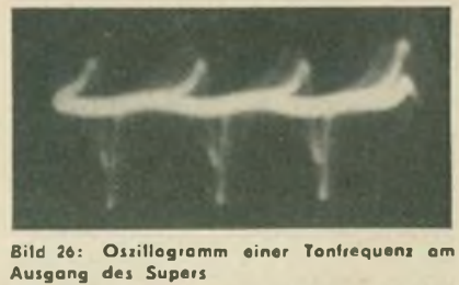
Bild 26: Oszillogramm einer Tonfrequenz am Ausgang des Supers
