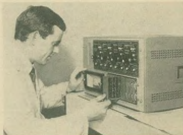
Bild 2: Die elektronische Regelungseinrichtung für Gewächshäuser besteht aus „ursamat“-Bausteinen und hat sich in der Praxis bereits bewährt
