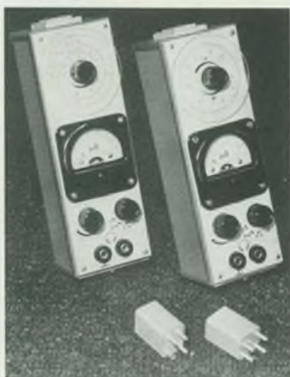
Bild 3: Die neuen Grid-Dip-Meter der Firma INCO, Wrocław, sind mit Transistoren bestückt. Beide Geräte unterscheiden sich in den Frequenzbereichen, und zwar 3 bis 250 MHz und 0,1 bis 30 MHz
