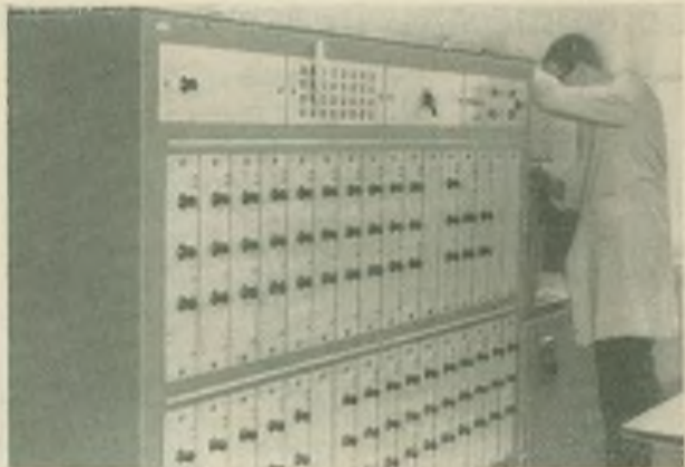
Bild 5: Die Typenfestlegung bei den Leistungstransistoren erfolgt vollautomatisch mit einem Meßautomaten nach maximal 32 voreingestellten Kennwerten
