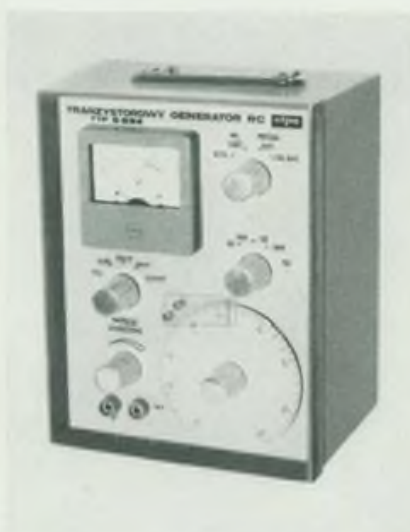
Bild 4: Mit Halbleiterbestückung arbeitet der RC-Generator „G-534“ der Firma ELPO, Warszawa. Frequenzbereich 20 Hz bis 20 kHz in 4 Bereichen, die Ausgangsspannung reicht von 0,3 mV bis 3 V
